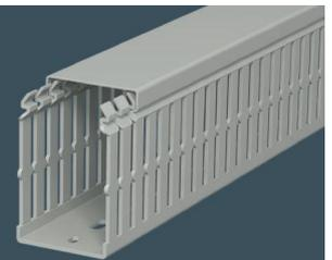
Das System LKV und LKV/N wird als DIN-Kanal bezeichnet, da er in seinen Abmessungen der alten DIN-Norm 43659 entspricht. 17 verschiedene Abmessungen von 25 x 25 mm bis 100 x 100 mm stehen zur Auswahl.
