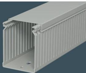
Mit dem System LK4 und LK4/N bietet OBO einen klassischen Verdrahtungskanal mit 21 etablierten metrischen Abmessungen von 15 x 15mm bis 80 x 120mm an. Eine passgenaue Verarbeitung ermöglicht ein leichtes Auf- und Abnehmen des Oberteils bei gleichzeitig festem Sitz.
