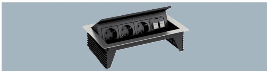
Klappbare Deskbox mit Anschlusskabel, für den festen Einbau in eine Tischplatte, Gehäuse aus gebürstetem Edelstahl mit Bürstenleiste als Leitungsauslass. Die Montage erfolgt über eine Einbauöffnung 245 x 157 mm in der Tischplatte.
