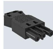
Buchsenteil 3-polig, Typ GST18i mit Schraubanschluss, geringe Bauhöhe (kein Steckplatzverlust in Kombination mit Verteilerblöcken), für Querschnitt 0,75 - 2,5 mm<sup>2</sup>, ein- und feindrätige Leiter ohne Aderendhülse anschließbar, für Leitungsdurchmesser von 6,5 - 10,5 mm (H05VV, NYM), unmontiert mit Zugentlastung, vor Ort konfektionierbar, 250 V, 16 A.
