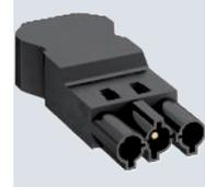
Steckerteil 3-polig, Typ GST18i mit Schraubanschluss für Leitungen 1,5 - 4,0 mm<sup>2</sup> und Leitungsdurchmesser von 10,5 - 14,5 mm (H05VV, NYM), unmontiert mit Zugentlastung, vor Ort konfektionierbar, 250 V, 16 A.
