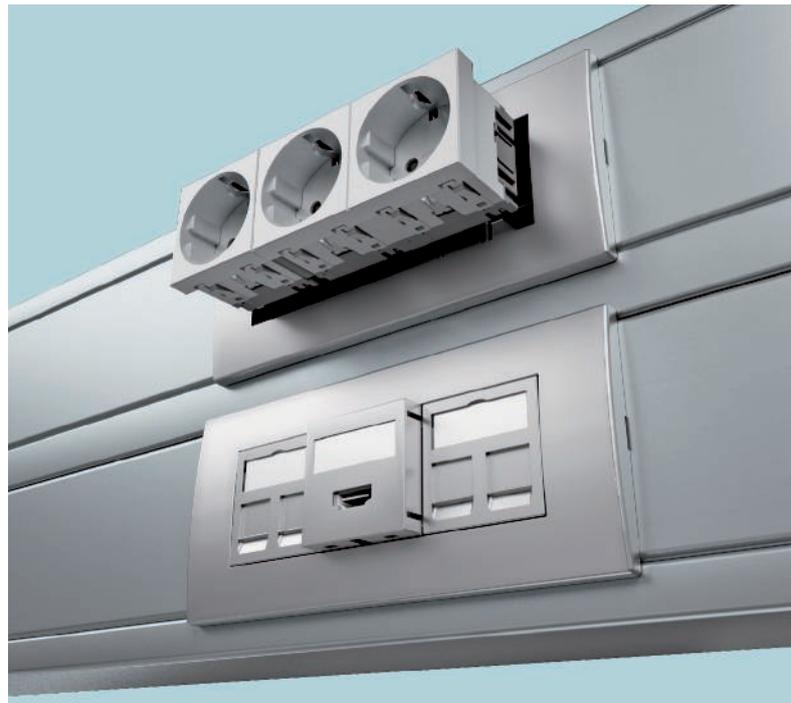
Modul 45-Geräte werden direkt, ohne weitere Bauteile, in den Kanal eingerastet. Die Einbauöffnung des Rapid45-Kanals ist auf das gesamte Programm an Modul 45-Geräten abgestimmt und bietet somit einen flächenbündigen Einbau.
