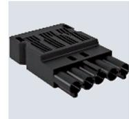
Steckerteil 5-polig, Typ GST18i mit Schraubanschluss für Leitungen 1,5 - 2,5 mm<sup>2</sup>, ein- und feindrätig, mit Zugentlastung, ein Anschluss pro Pol, unmontiert, für Leitungen H05VV (Ø 9,5 - 13,5) NYM und (Ø 10,5 - 13,5 mm), verriegelbar, gemäß Zugentlastung nach VDE 0628 ist eine Verriegelung vorzusehen, 250 V, 16 A.
