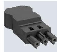
Buchsenteil 3-polig, Typ GST18i mit Schraubanschluss für Leitungen 1,5 - 4,0 mm<sup>2</sup> und für Leitungsdurchmesser von 10,5 - 14,5 mm (H05VV, NYM), unmontiert mit Zugentlastung, vor Ort konfektionierbar, 250 V, 16 A.
