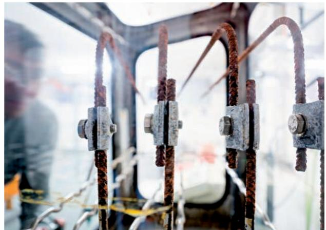
Bild 4: BET-SO<sub>2</sub>-Prüfanlage
