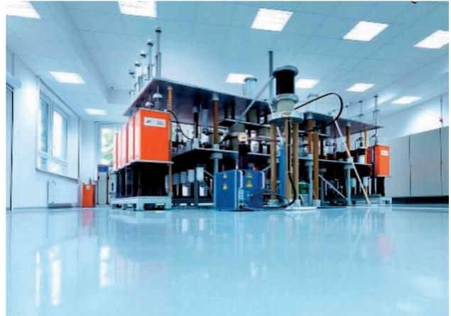
Bild 3: BET-Testgenerator
